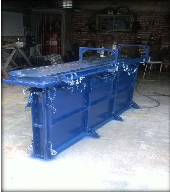
Imagen 14 y 15: Diseño de Cimbras para barra en cocina-comedor, Fraccionamiento Ario 1815. Fuente: propia
